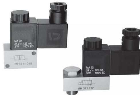
Direkt betätigtes 3/2-Wege Magnetventil, normal geschlossen, für Tieftemperaturanwendungen  $-50\text{ °C}$  bis  $+50\text{ °C}$ .
