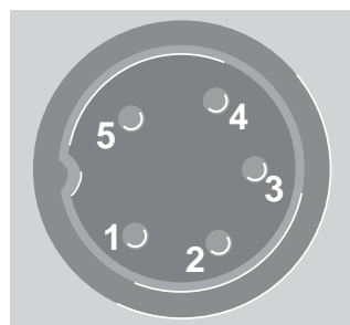
Abb. 7: Belegung des Steckers für Funk- tionsüberwachung und externe Frei- gabe (Kontakte in Ruhestellung)
