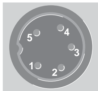
Abb. 6: Belegung des Steckers für Funk- tionsüberwachung (Kontakt in Ruhe- stellung)
